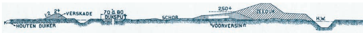
Afb. 3. Achterkade, dijkspuit en voorkade. Ontleend aan P.J. Colijn, Zee- en rivierwerken (Amsterdam 1921).
