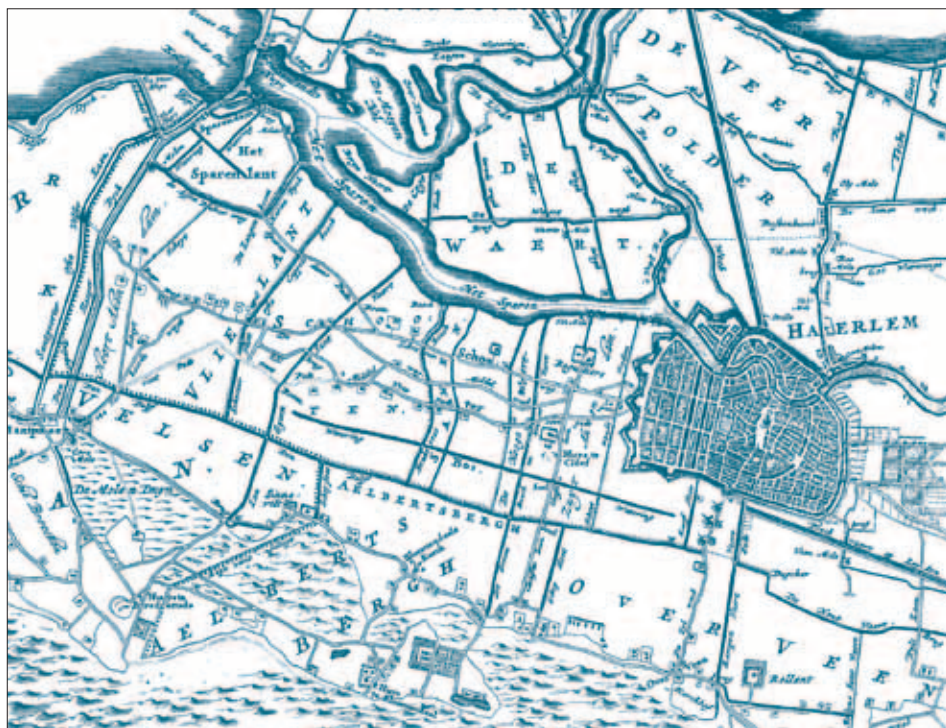
Afb. 1. De Delf of Delft bij Haarlem is vermoedelijk gegraven in de tweede helft van de twaalfde eeuw ter ontwatering van de strandlakte benoorden van de Zijkweg (noorden links). Detail van de kaart van het Hoogheemraadschap van de Uitwaterende Sluizen, 1745. Collectie Hoogheemraadschap Hollands Noorderkwartier, Heerhugowaard.
